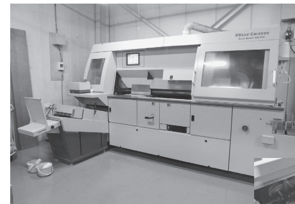
稼働するBQ-480自動無線綴じ機 PUR製本/EVA製本に対応
